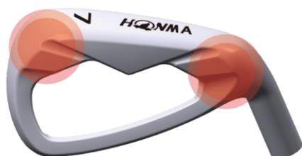
チタンフェイスを採用することで、ヘッドの大型化に成功し、ソールとトップブレードを肉厚にすることで慣性モーメントがUP。さらに、トゥとヒールにウエイトを配すことで、インパクト時のヘッドのブレを軽減。当たり負けが少なく、高い直進性と安定したショットを実現。
