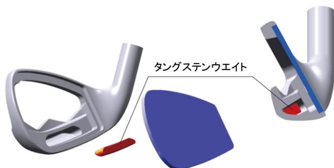
ソール下部の後方側に 10g のタングステンウエイトを装着。低・深重心でラクにボールをとらえ、理想的な高弾道を実現。
